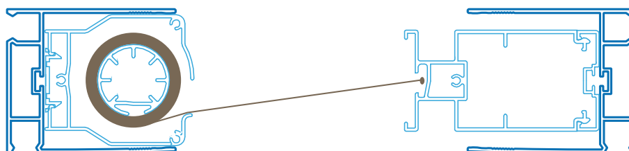
Versione "A scomparsa": con zanzariera senza profilo di riscontro (minor visibilità della barramaniglia a zanzariera attiva)
