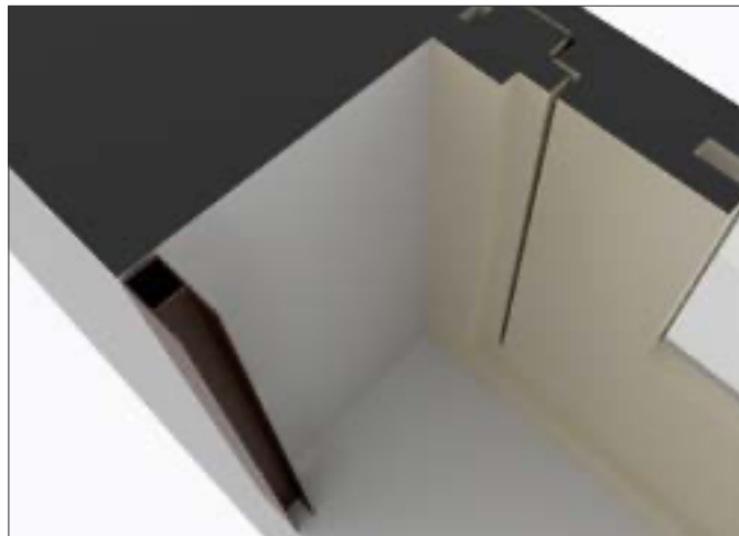
Cassonetto in luce in larghezza e altezza con avvolgimento verso l'esterno (INVERSIONE) con box sporgente
