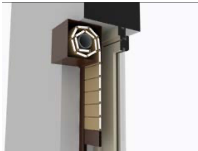
Cassonetto in luce in larghezza, fuori luce in altezza con avvolgimento verso l'esterno (INVERSIONE) con box sporgente
